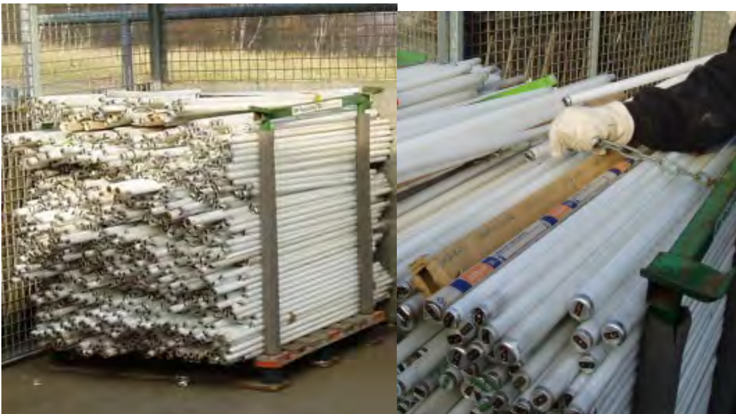
Abb. 25: Schlechte Stapelung von Leuchtstoffröhren auf Rungenpaletten (Bildquelle: INTECUS)
