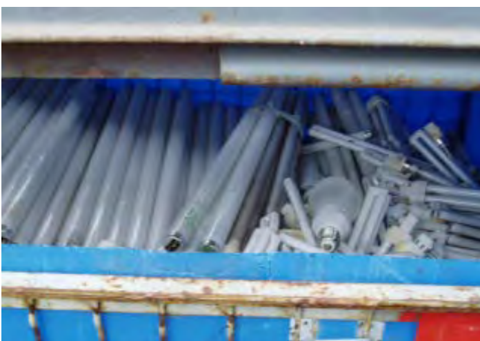
Abb. 27: Gute Praxis zur bruchvermeidenden Befüllung der Gitterboxen (Bildquelle: INTECUS)
