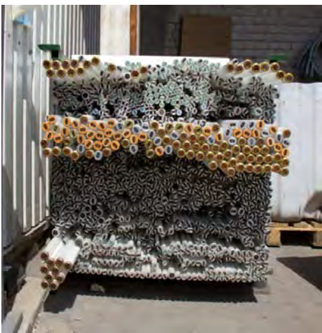
Abb. 12: Rungenpalette mit Leuchtstoffröhren variabler Länge (Bildquelle: Ökopol)
