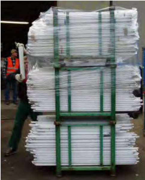
Abb. 20: Ladungssicherung mit Stretchfolie (Bildquelle: INTECUS)
