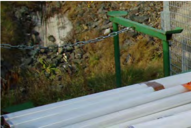
Abb. 28: Geschlossene Fixierkette an einer Rungenpalette (Bildquelle: INTECUS)
