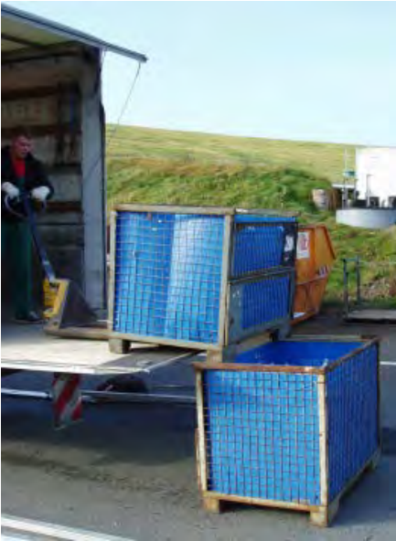
Abb. 23: Behälterstapelung mittels Hubwagen und Ladebordwand (Bildquelle: INTECUS)
