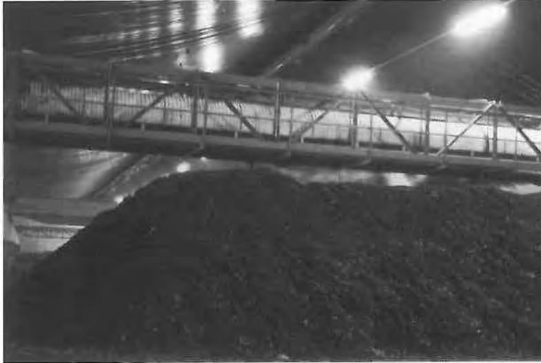
konstruktion überdacht. Zum Schutz der konstruktiven Teile der Halle wurde eine Plastikfolie abgehängt. Die Rotteabluft wird abgesaugt und anschließend in Kompostfiltern desodoriert.
