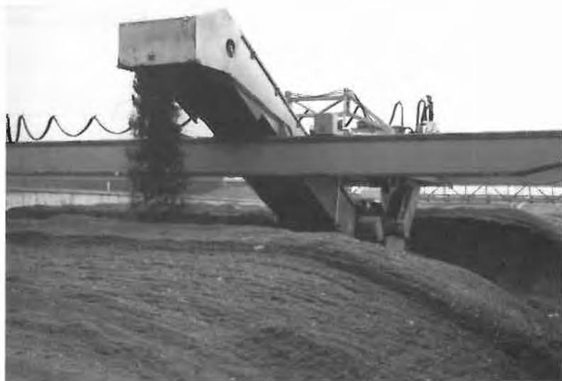
Abb. 10. 16: Restabfallbehandlungsanlage Oberpullendorf nach dem Einhausen (Ausbauphase 1989) – Materialeintrag auf die belüftete Rotteplatte
