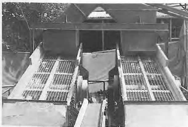
Bild 2.8. Zwei Vibrationssiebe mit Hosenrutsche als nach- geschaltete Trennaggregate
