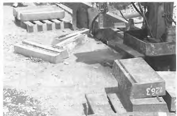
Bild 2.6. Schlagleistenzustand einer Prallmühle vor und nach dem Gebrauch
