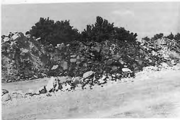
Bild 1.3. Unverarbeiteter Straßenaufbruch mit großen Asphaltplatten
